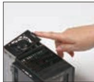
拆下变频器顶部盖板
