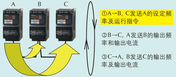
应用事例: 通过A的操作器实现对B, C的设定频率调整及输出频率、输出电流监控。
