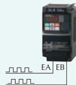
示例: 脉冲串速度控制
